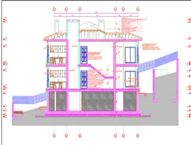
Şekil 5. Yapı A-A Kesiti
